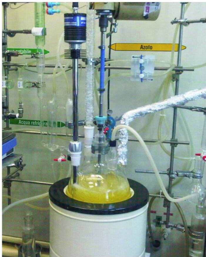
ReactaVisc in laboratorio durante sintesi di resina
