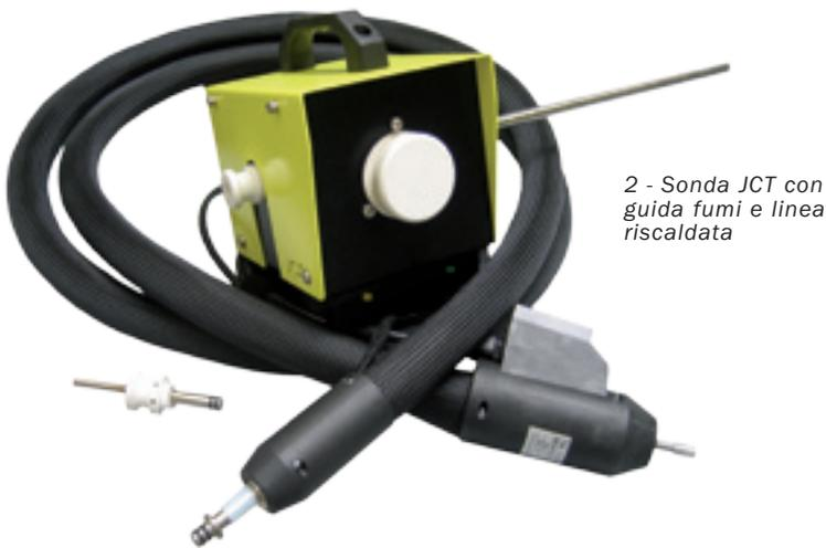
2 - Sonda JCT con guida fumi e linea riscaldata
